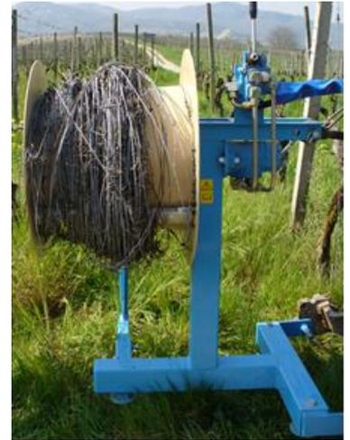
Der Traktor mit dem Aufwickler steht in Fahrtrichtung, so dass die Drahtführung mittig in Richtung der Zeilengasse positioniert ist. Wenn die Drahtenden an der Wickeltrommel befestigt sind, kann der Traktor gestartet und die Hydraulik eingeschaltet werden. Die Trommel läuft so lange, wie der Bedienungshebel bzw. Steuerhebel gezogen wird. Wird der Steuerhebel losgelassen, bleibt die Wickeltrommel **sofort** stehen. Ein Nachlauf ist nicht möglich.
