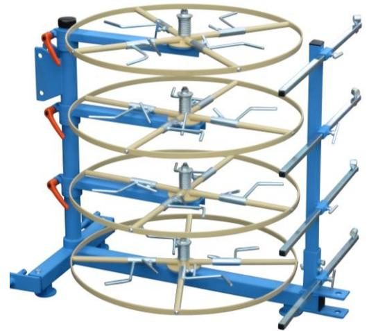
Die Drähte werden während der Fahrt auf einmal abgewickelt und verlegt. Eine zweite Person geht mit und hängt die Drähte gleich am Pfahl ein. Die Haspelringe sind mit einer Nachlaufbremse ausgerüstet, was ein gleichmäßiges Abwickeln gewährleistet. Zum Laden neuer Drahtrollen können die Haspelringe ausgeschwenkt werden.
